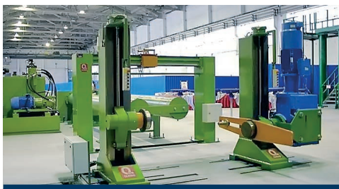
Статическая вытяжка для больших канатов Ø 19-90 мм
