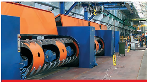
Динамическая вытяжка для средних канатов Ø 15-35 мм
